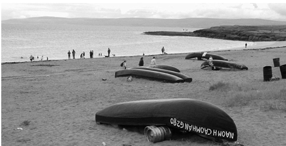
Fig. 6. Le "currach" sono le tipiche imbarcazioni usate da secoli dai pescatori delle isole Arann. La loro particolare struttura a prora rialzata le rende adatte ad affrontare le forti ondate dell'Oceano Atlantico. In genere quando sono in secco esse sono posizionate capovolte sopra i fusti vuoti di Guinness, la tradizionale birra irlandese, in modo da non alterarne la curvatura. Quasi tutte le currach hanno nomi di santi tradizionali in modo da assicurarsi la sua protezione in mare. Quella in primo piano nella figura è chiamata "Naomh Caomhàn" cioè grosso modo
